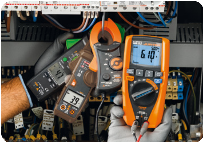
电流测量比较: 3.9A: 用有效值电流钳表 - 4.7A: 通过真有效值电流钳表 6.1A: 通过用 AC+DC TRMS真有效值电流钳的准确读数
